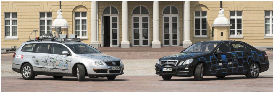
Abb. 1: Automatische Fahrzeuge mit umfangreicher Sensorik auf dem Dach (links), bzw. im Fahrzeug verbaut (rechts).
